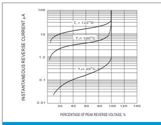
Fig.3-TYPICAL REVERSE CHARACTERISTIC
