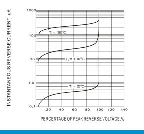
Fig.4-TYPICAL REVERSE CHARACTERISTIC
