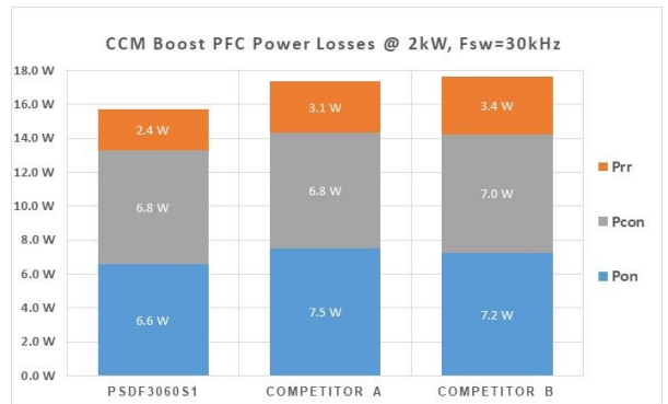
(d) Power loss @ 2kW, 220Vac, 400VDC,
