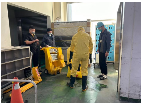
▲使用洩漏處理台車進行化學品洩漏處理
